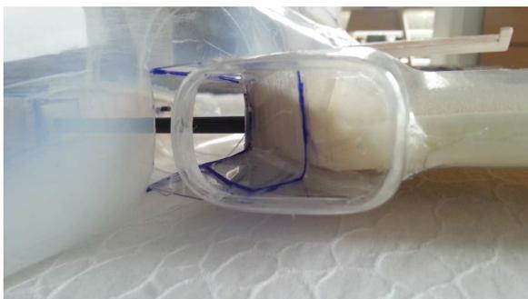
di uscita accoppiando la semi ala alta con quella bassa, chiudere l' ultimo lato, quello verso la fusola con lo stesso sistema, lasciando il pezzetto di tubo di carbonio che fuoriesce per poi infilarlo nella fusoliera.
